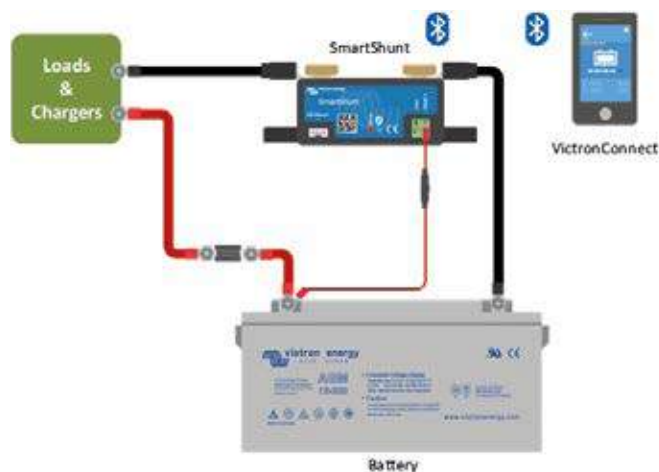
Câblage de base du SmartShunt
